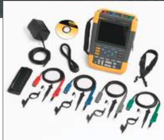
Los Fluke 190 Serie II incluyen un juego de sondas de tensión (2 ó 4, en función del modelo), correa de transporte, cable USB con conector mini-B, batería de ion-litio de doble capacidad BP291, cargador de baterías/adaptador de alimentación BC190, un paquete de demostración del software FlukeView y manuales de usuario en CD.
