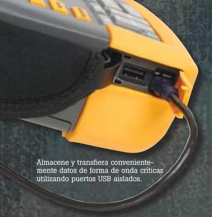
Almacene y transfiera convenientemente datos de forma de onda críticas utilizando puertos USB aislados.
