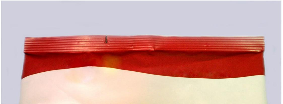
Un corte de rasgado hace que los paquetes producidos en envasadoras de tipo vertical/llenado/ sellado se abran mas fácilmente. Este pequeño corte en el sello final permite a los consumidores rasgar la película con facilidad para tener acceso al producto.
