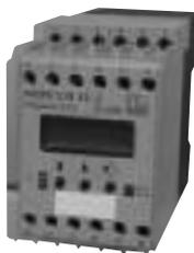
En combinación con los reductores con variador mecánico VARIBLOC® (consulte el catálogo de reductores con variador mecánico), en lugar del regulador de velocidad se utiliza un monitor de deslizamiento para comprobar la diferencia de velocidad entre las mitades de entrada y salida del acoplamiento.
